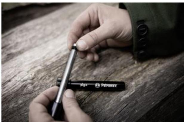
1. Dévisse le piston à feu et monte un des joints. Veille à ce qu'il soit bien placé. Le joint doit s'élargir d'environ 1 mm lors du vissage.
