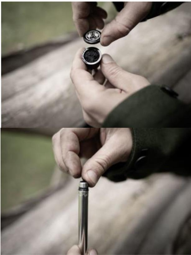
3. Prends un morceau d'amadou de la taille d'un petit pois dans le réservoir du piston et place-le dans la chambre d'allumage. L'amadou doit être bien placé dans la chambre sans dépasser.
