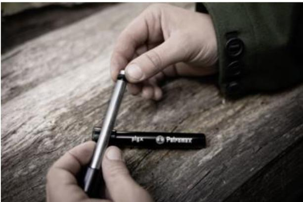
1. Schraube die Kolbenspitze ab und montiere einen der Dichtungsringe. Achte dabei auf einen festen und korrekten Sitz. Der Dichtungsring muss beim Verschrauben um ca. 1 mm geweitet werden.
